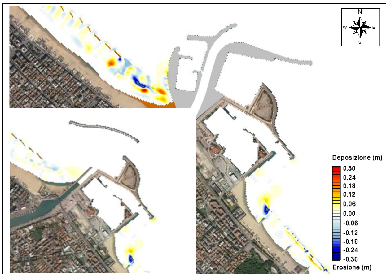
Figura 4.94 – TEST 3P (Tramontana) frequenza 5 gg/anno – Evoluzione dei fondali con D_{50} pari a 0.25 mm
