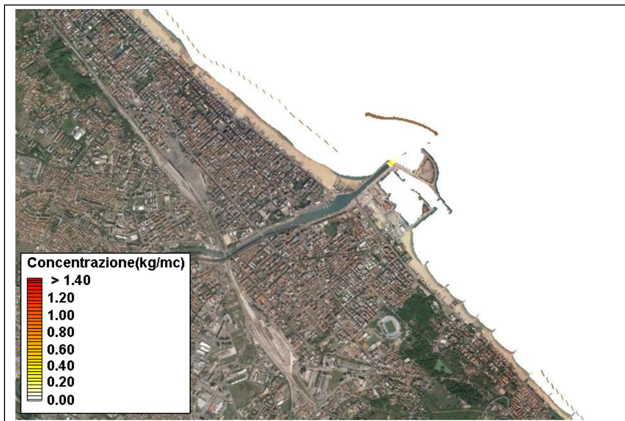
Figura 4.61 – TEST 8 - Tramontana 1 g/anno con piena Tr = 2 anni ( 1'000 \text{ m}^3 ) – Trasporto solido con D_{50} pari a 0.05 mm
