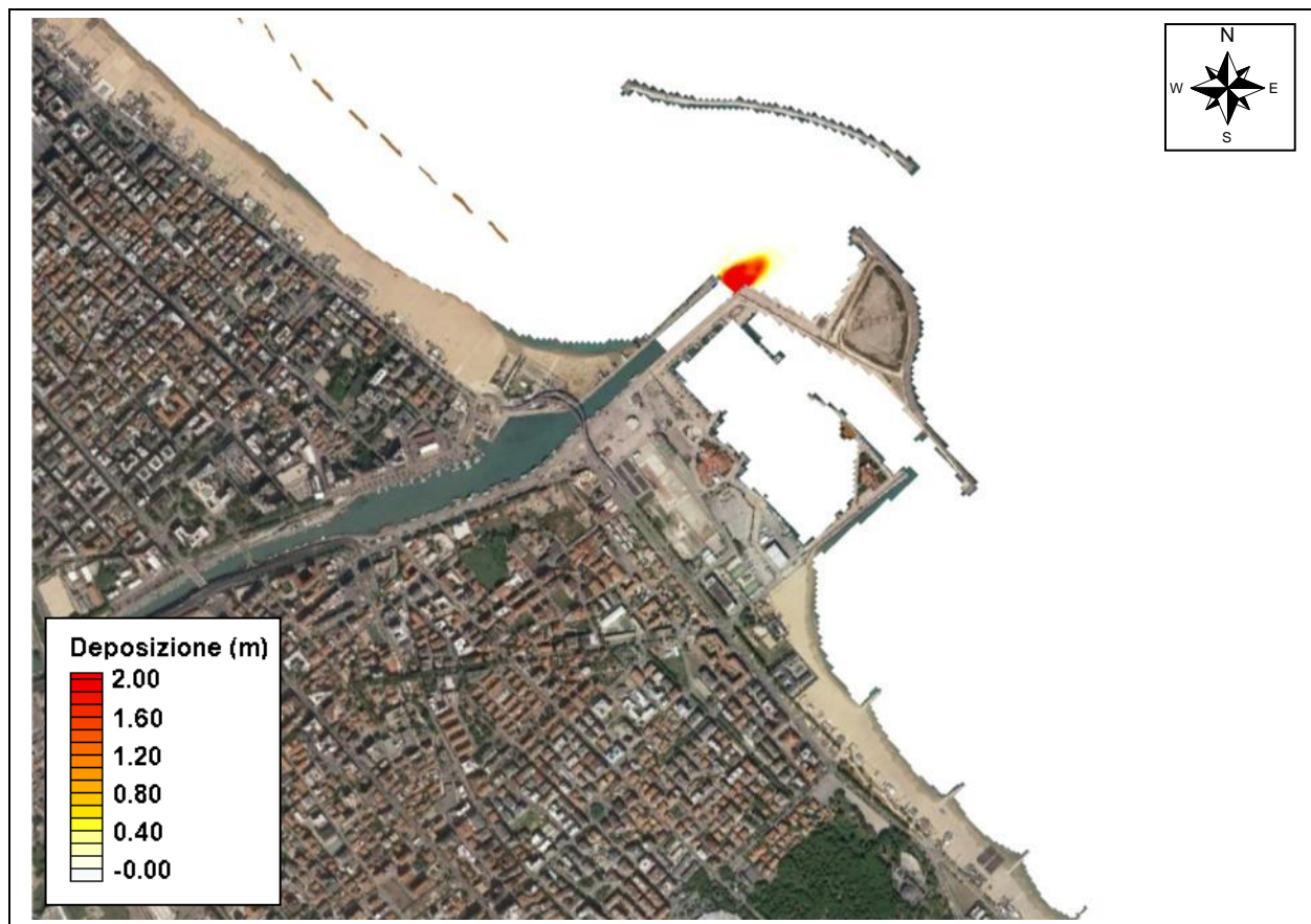
Figura 4.66 – TEST 7 - Tramontana 1 g/anno con piena Tr = 2 anni ( 10'000 \text{ m}^3 ) – deposizione dei sedimenti con D_{50} pari a 0.05 mm
