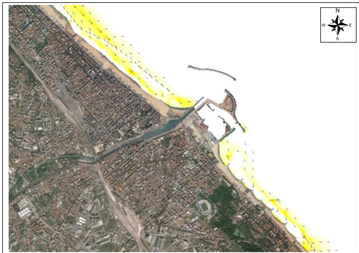
Figura 4.40 – TEST 3 (Tramontana) frequenza 5 gg/anno – Trasporto solido D_{50} pari a 0.25 mm
