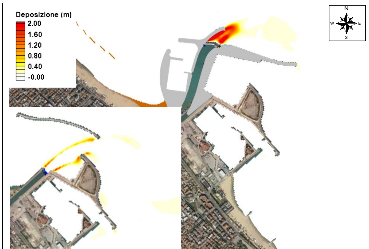
Figura 4.105 – TEST 5AP - Tramontana 1 g/anno con piena Tr = 25 anni – deposizione sedimenti del F. Pescara con D_{50} pari a 0.05 mm
