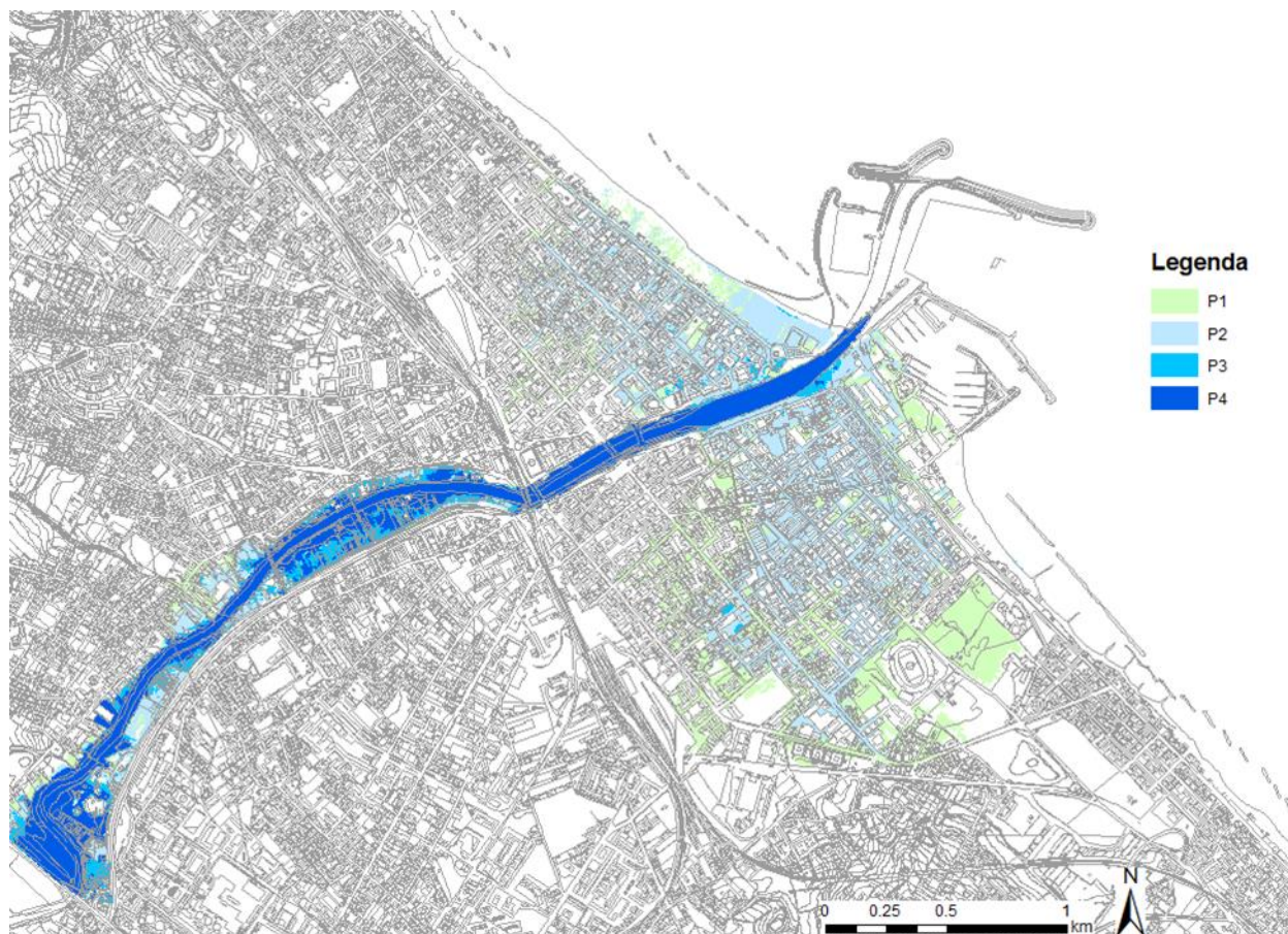
Figura 2.55 – Risultati del modello idraulico con batimetria modificata: pericolosità nello stato di fatto con porte chiuse, casse di espansione funzionanti a monte e PRP (configurazione 5).
