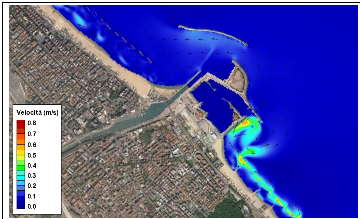
Figura 4.31 – TEST 2 (Levante) frequenza 1 g/anno – Circolazione idrodinamica – Dettaglio area portuale
