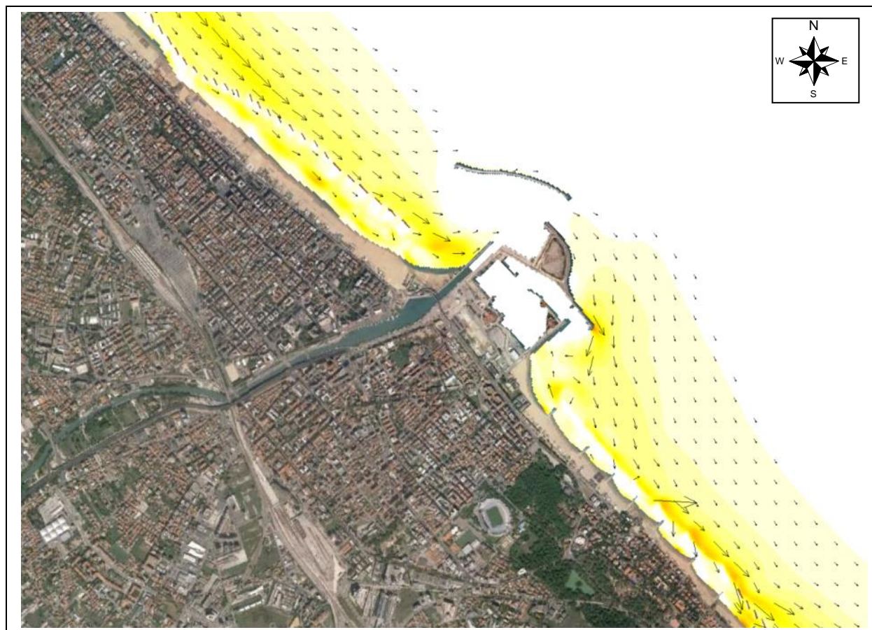
Figura 4.36 – TEST 1 (Tramontana) frequenza 1 g/anno – Trasporto solido con D_{50} pari a 0.25 mm
