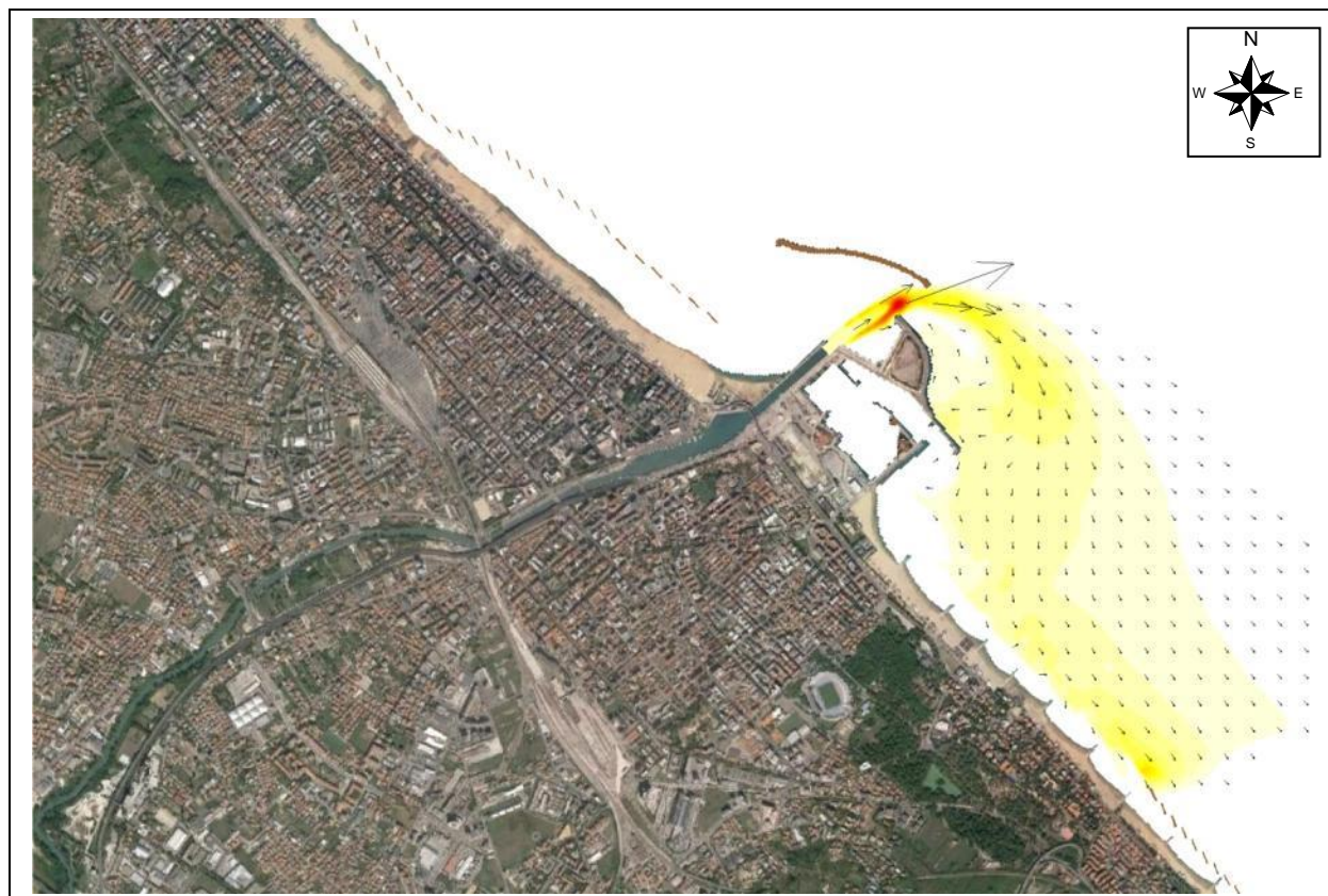
Figura 4.56 – TEST 5 - Tramontana 1 g/anno con piena Tr = 25 anni – Trasporto solido con D_{50} pari a 0.25 mm
