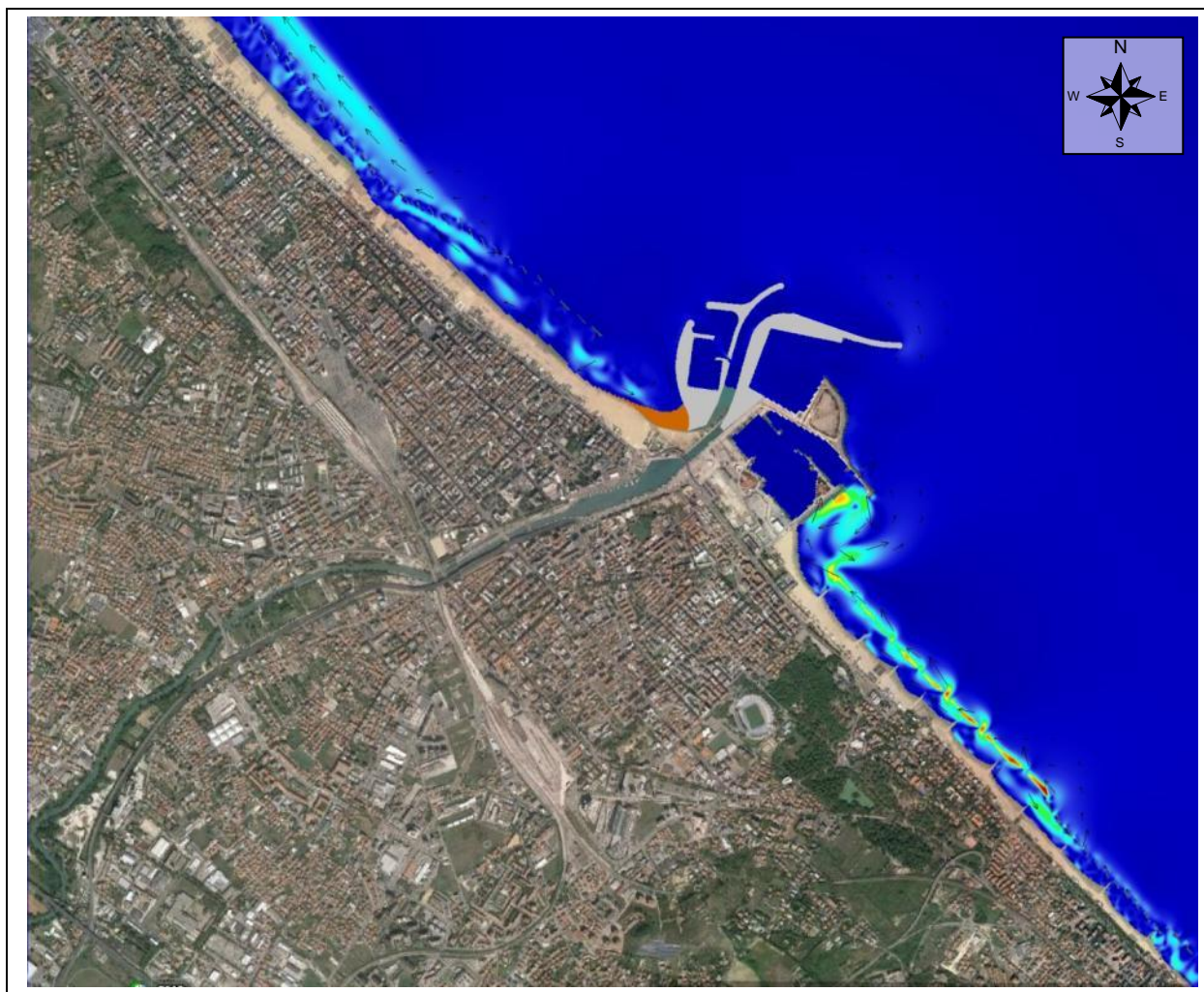
Figura 4.78 – TEST 2P (Levante) frequenza 1 g/anno – Circolazione idrodinamica
