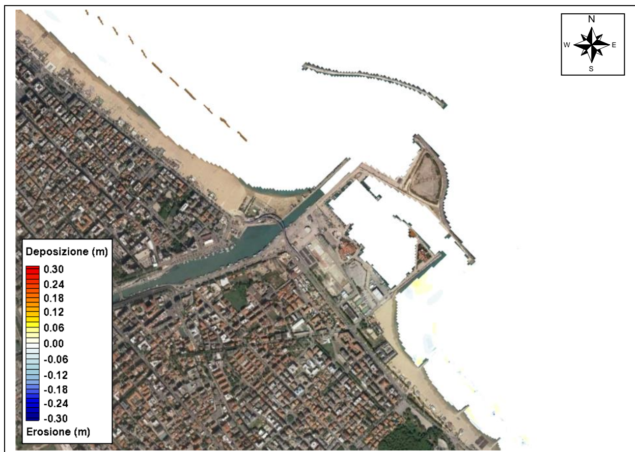
Figura 4.47 – TEST 4 (Levante) frequenza 5 gg/anno – Evoluzione dei fondali con D_{50} pari a 0.25 m
