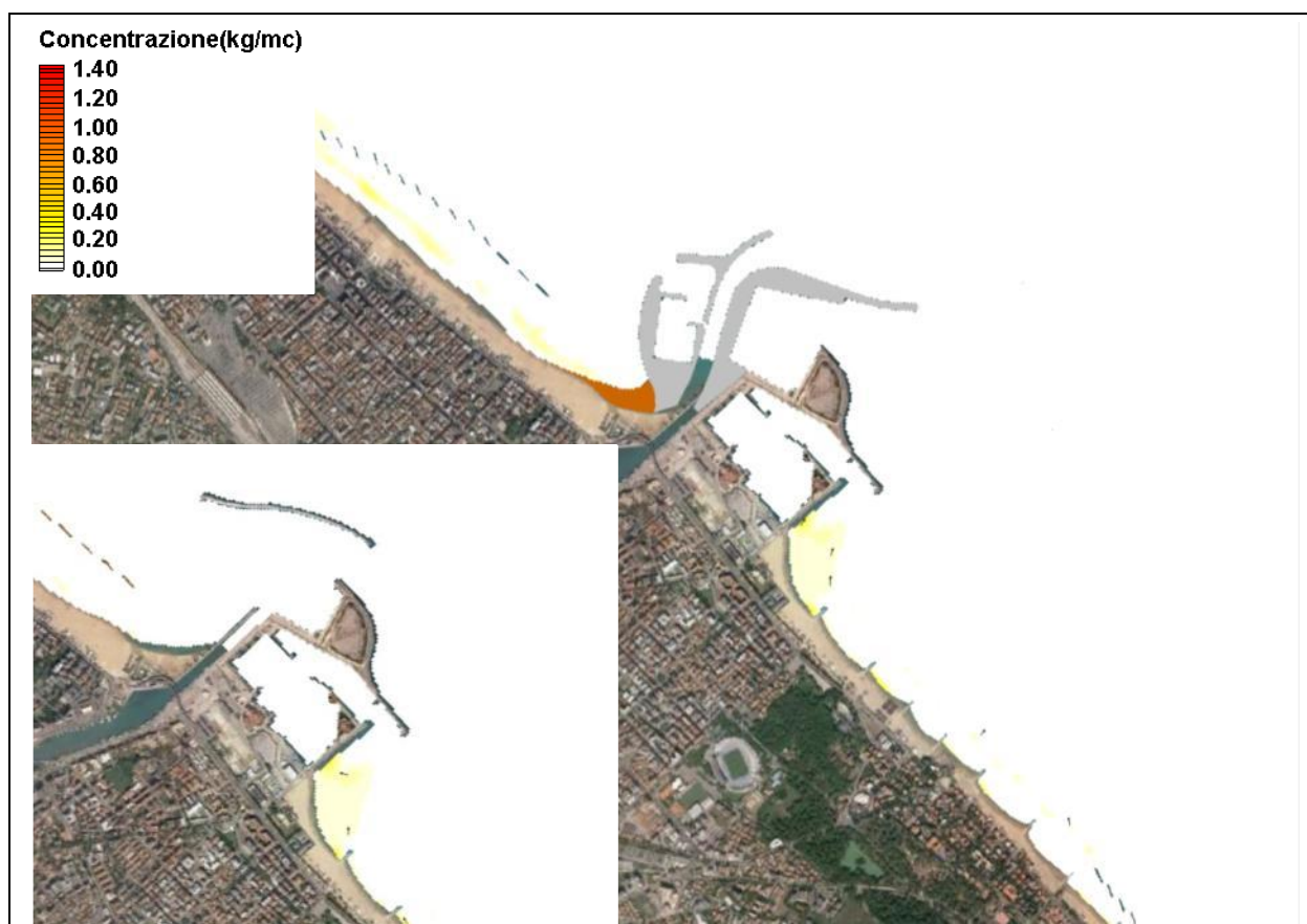
Figura 4.89– TEST 4P (Levante) frequenza 5 gg/anno – Trasporto solido con D_{50} pari a 0.25 mm
