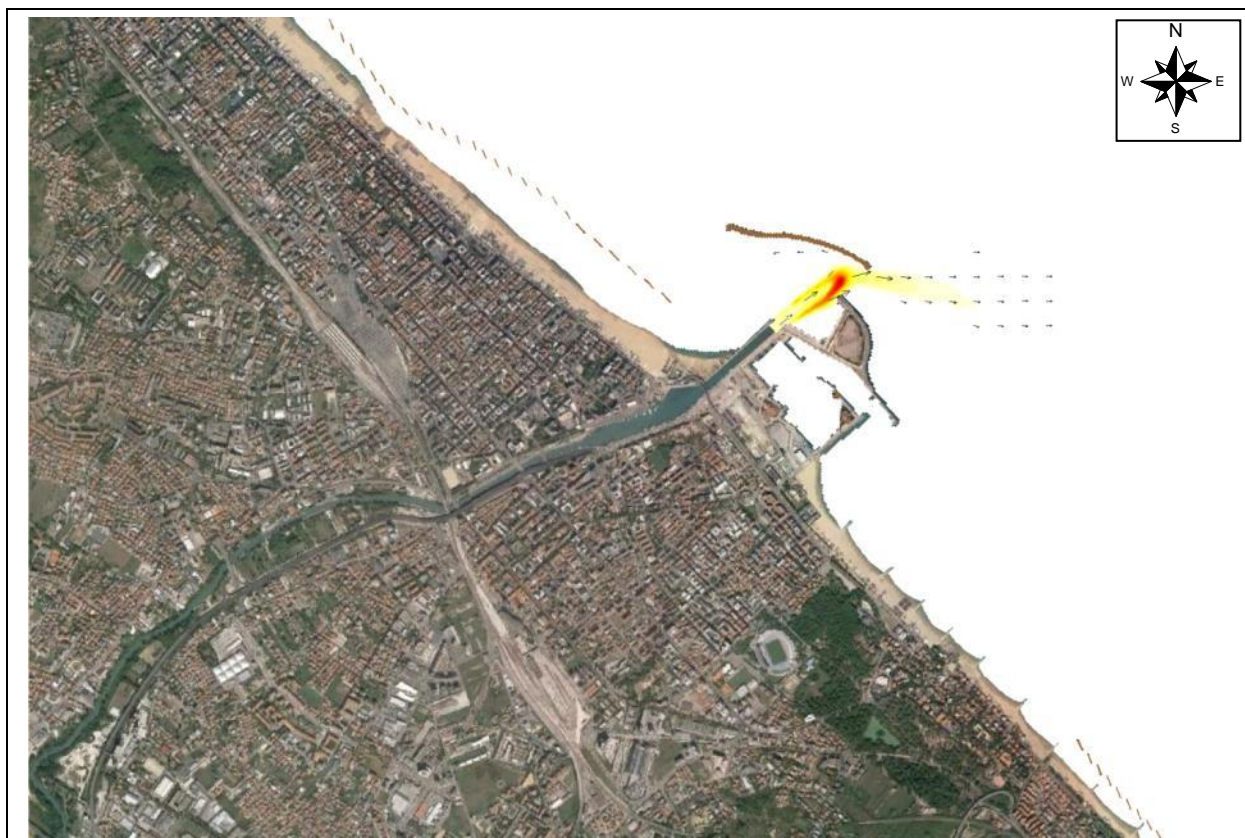
Figura 4.58 – TEST 6 - Levante 1 g/anno con piena Tr = 25 anni – Trasporto solido con D_{50} pari a 0.25 mm
