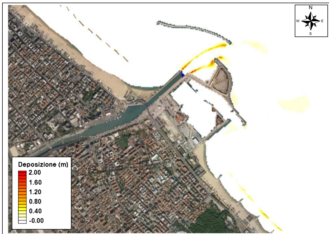
Figura 4.63 – TEST 5A - Tramontana 1 g/anno con piena Tr = 25 anni – deposizione dei sedimenti del F. Pescara con D_{50} pari a 0.05 mm
