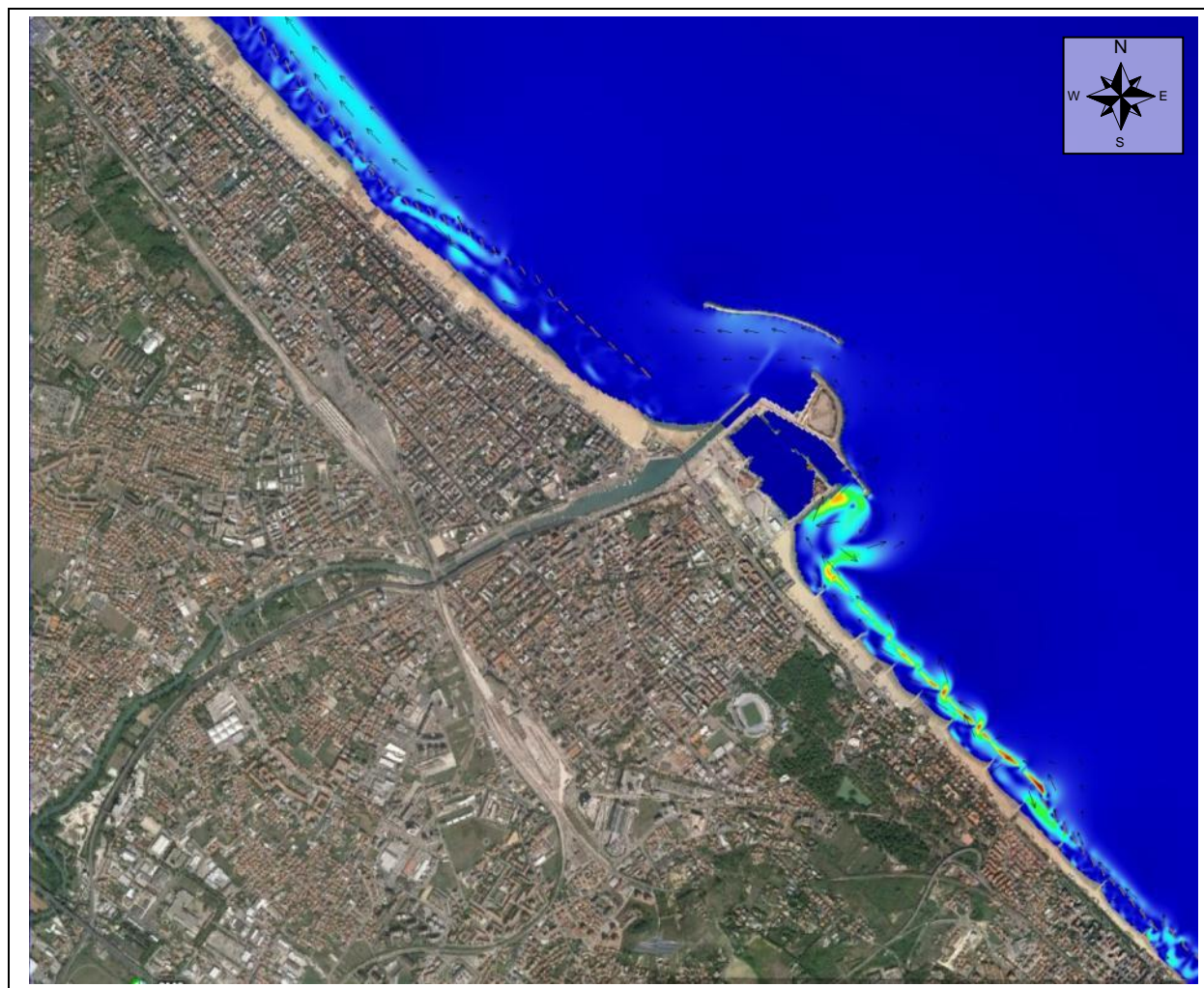
Figura 4.30 – TEST 2 (Levante) frequenza 1 g/anno – Circolazione idrodinamica
