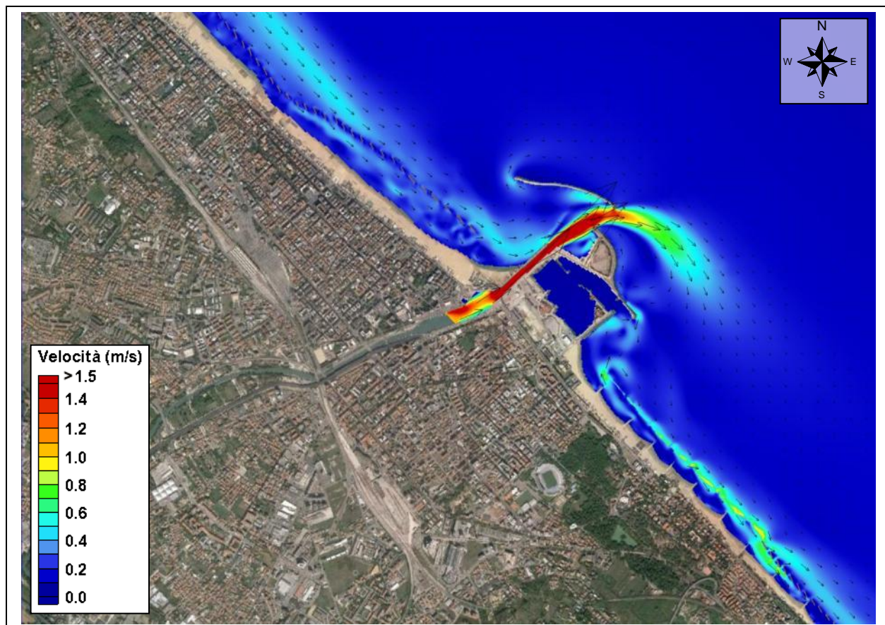
Figura 4.53 – TEST 5 - Tramontana frequenza 1 g/anno concomitante ad evento di piena Tr = 25 anni – Circolazione idrodinamica
