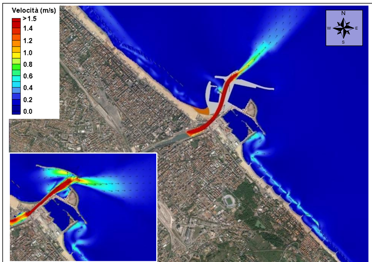
Figura 4.99 – TEST 6P - Levante frequenza 1 g/anno concomitante ad evento di piena Tr = 25 anni – Circolazione idrodinamica
