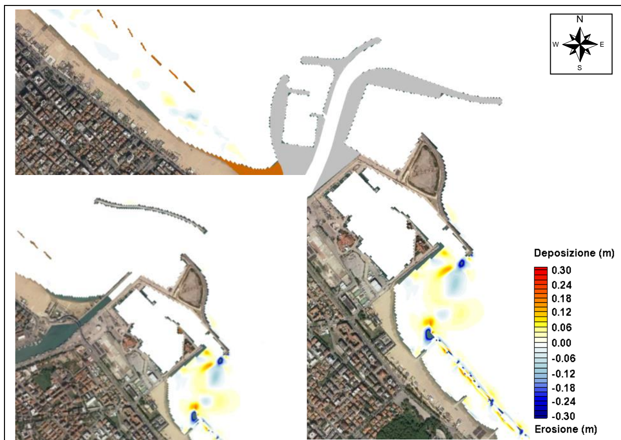
Figura 4.92 – TEST 2P (Levante) frequenza 1 g/anno – Evoluzione dei fondali con D_{50} pari a 0.25 mm
