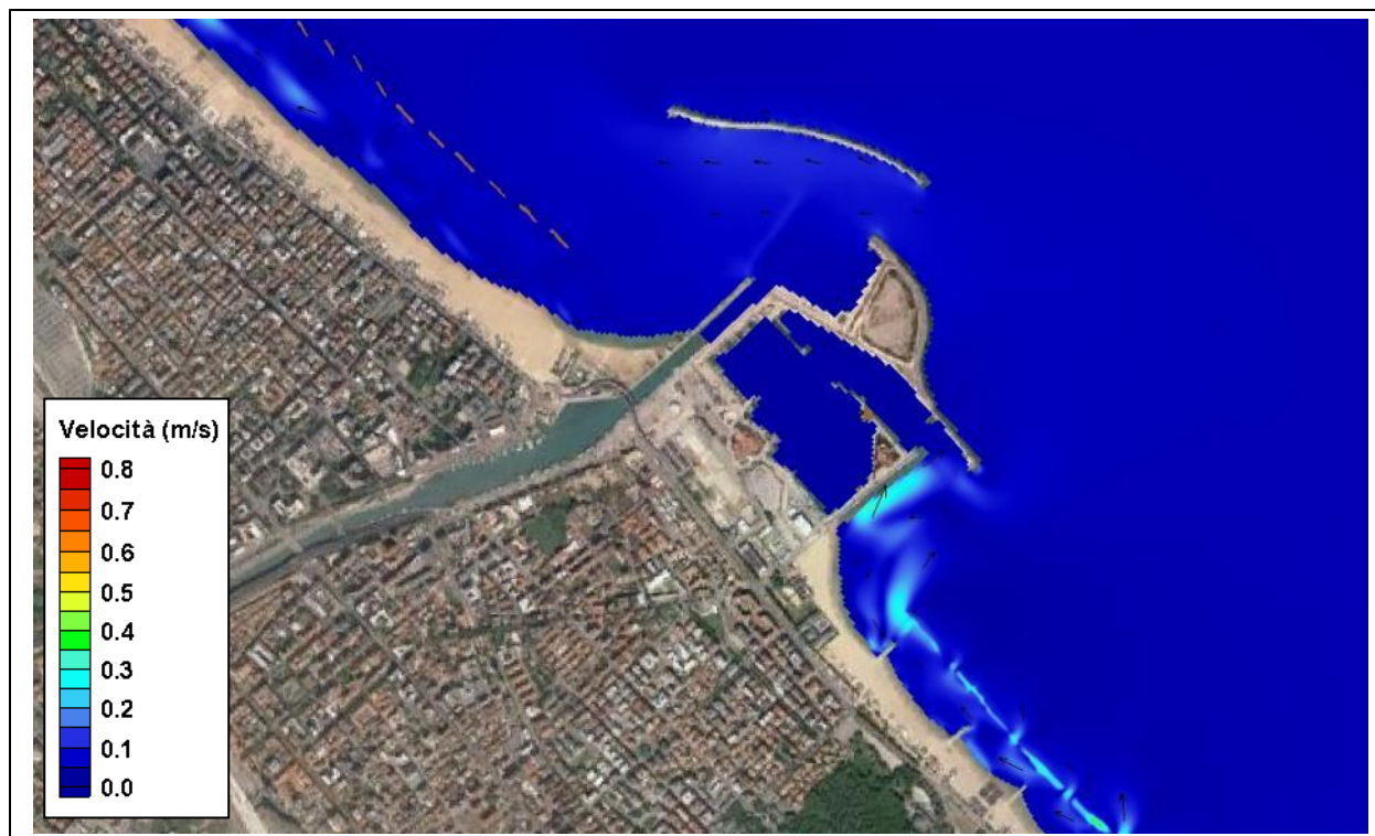
Figura 4.35 – TEST 4 (Levante) frequenza 5 gg/anno – Circolazione idrodinamica – Dettaglio area portuale
