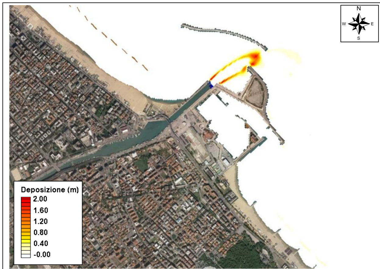
Figura 4.62 – TEST 5 - Tramontana 1 g/anno con piena Tr = 25 anni – deposizione dei sedimenti del F. Pescara con D_{50} pari a 0.25 mm
