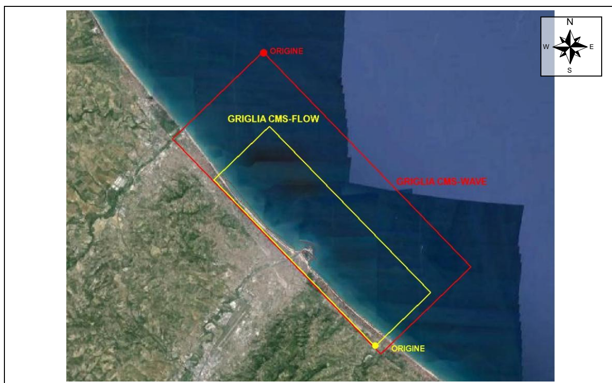
Figura 4.22– Domini di calcolo impiegati per lo studio della propagazione e della circolazione
