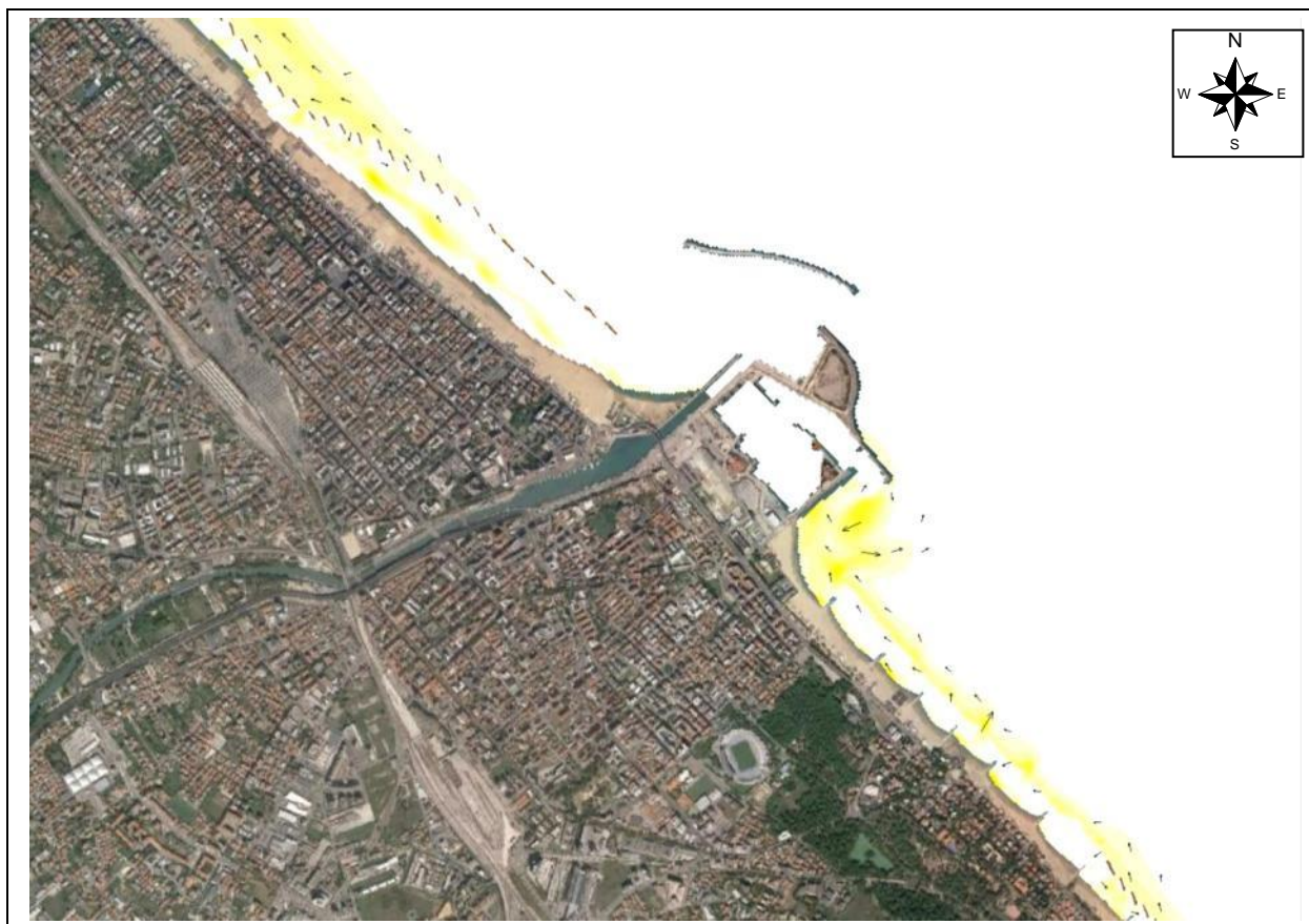
Figura 4.38 – TEST 2 (Levante) frequenza 1 g/anno – Trasporto solido con D_{50} pari a 0.25 mm
