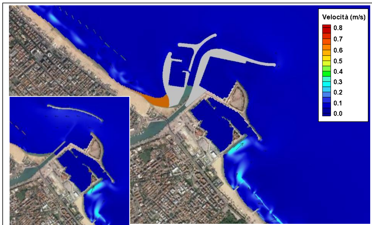
Figura 4.83 – TEST 4P (Levante) frequenza 5 gg/anno – Circolazione idrodinamica – Dettaglio area portuale
