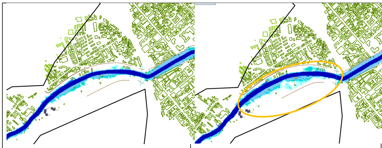
Figura 2.65 – Differenze delle aree allagate in condizioni idrometriche ottenute per un evento con portata al colmo pari a 600 \text{ m}^3/\text{s} , senza ostruzione dei ponti (a sinistra) e con un'ostruzione del 25% (a destra).
