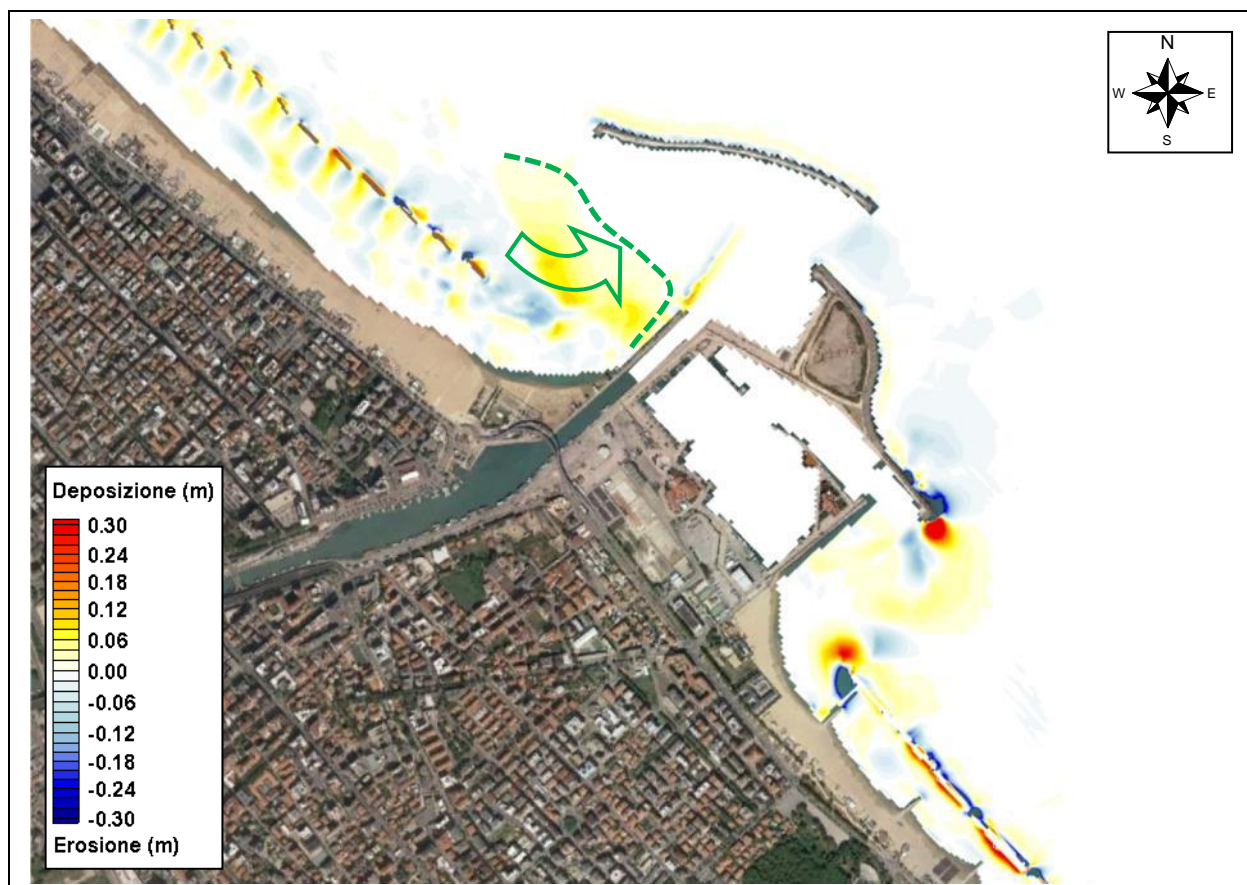
Figura 4.42– TEST 1 (Tramontana) frequenza 1 g/anno – Evoluzione dei fondali con D_{50} pari a 0.25 mm
