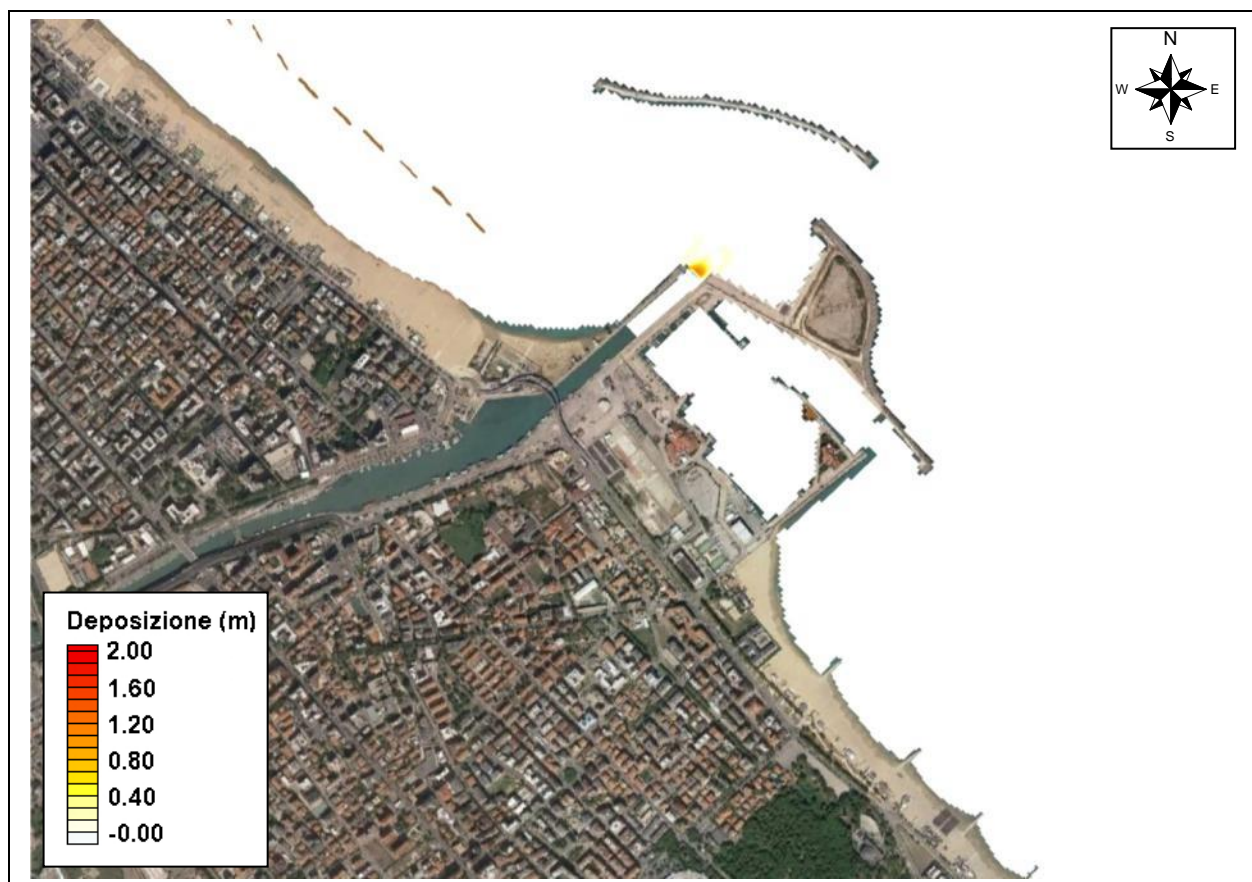
Figura 4.67 – TEST 8 - Tramontana 1 g/anno con piena Tr = 2 anni ( 1'000 \text{ m}^3 ) – deposizione dei sedimenti con D_{50} pari a 0.05 mm
