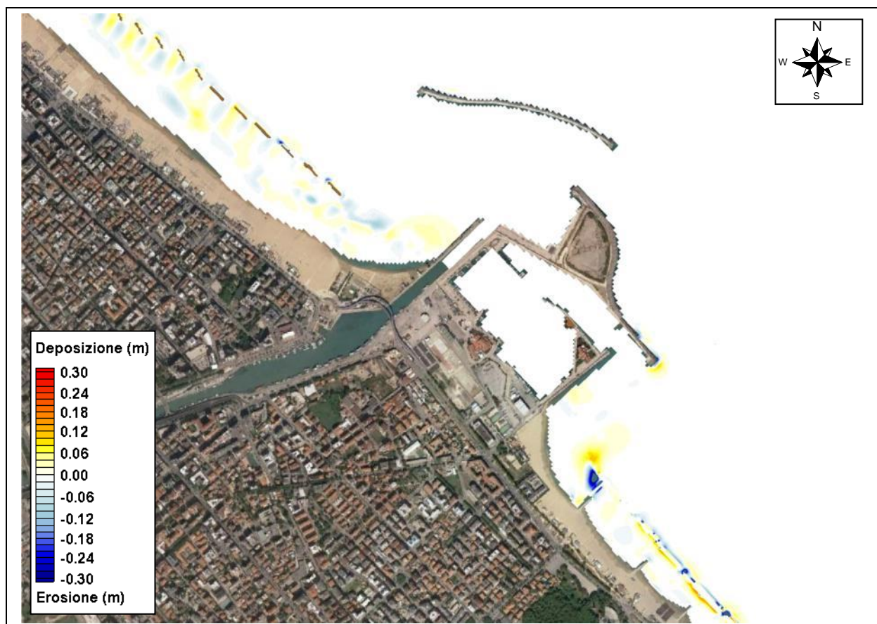
Figura 4.46 – TEST 3 (Tramontana) frequenza 5 gg/anno – Evoluzione dei fondali con D_{50} pari a 0.25 mm
