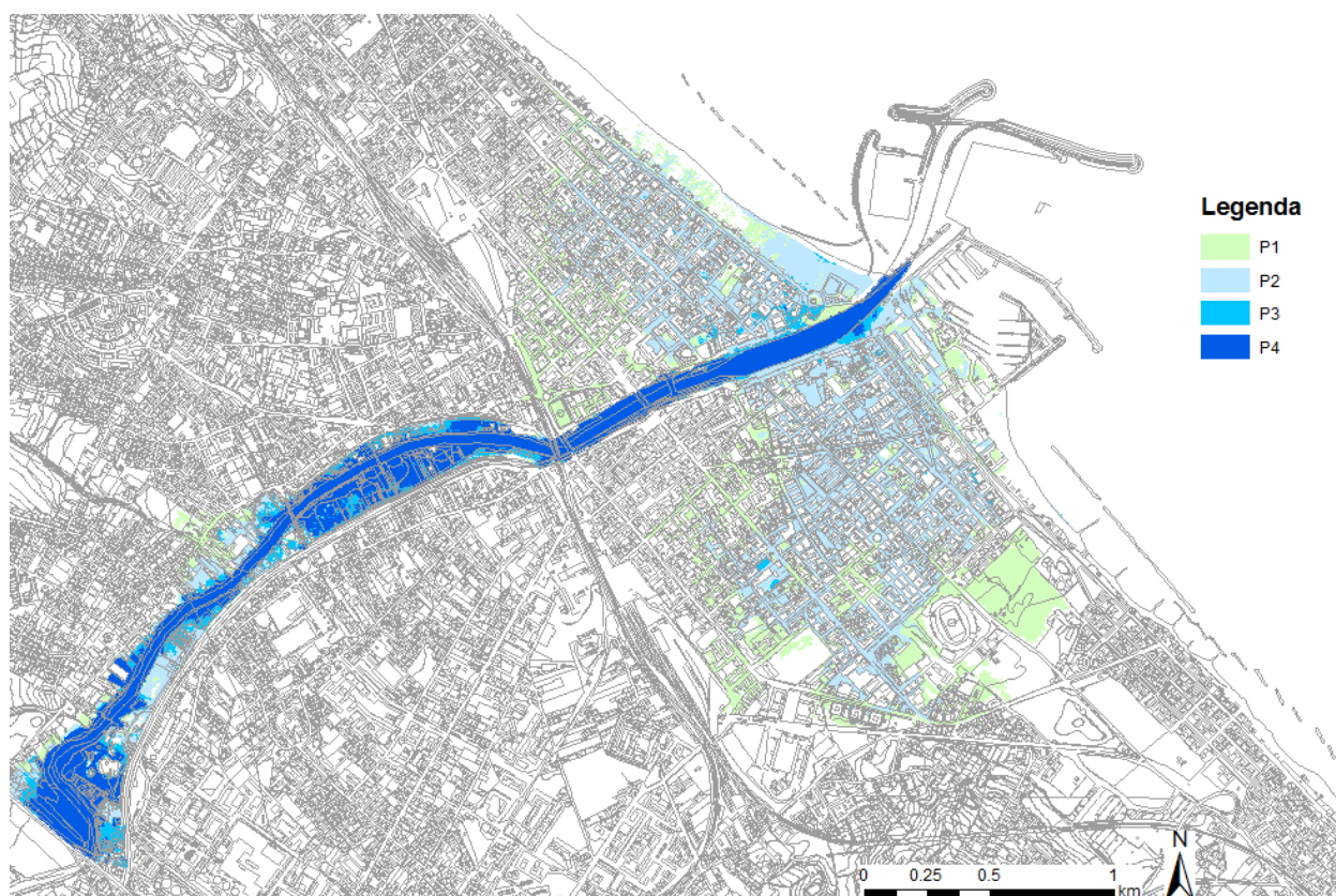
Figura 2.50 – Risultati del modello idraulico: pericolosità nello stato di fatto con porte chiuse, casse di espansione funzionanti a monte e PRP (configurazione 5).
