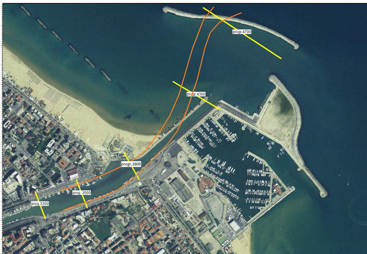
Figura 3.17 – Planimetria su ortofoto stato attuale con indicazione del fiume nella configurazione da PRP e delle progressive per la lettura dei profili di cui alle successive figure .
