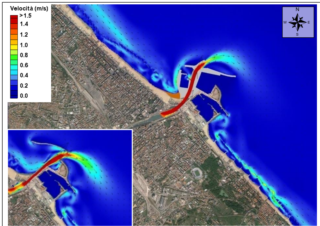
Figura 4.98 – TEST 5P - Tramontana frequenza 1 g/anno concomitante ad evento di piena Tr = 25 anni – Circolazione idrodinamica
